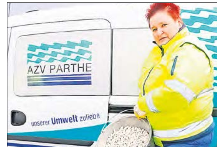
Das Granulat wird im Biofilter eingesetzt und hilft, schlechte Gerüche zu binden.
